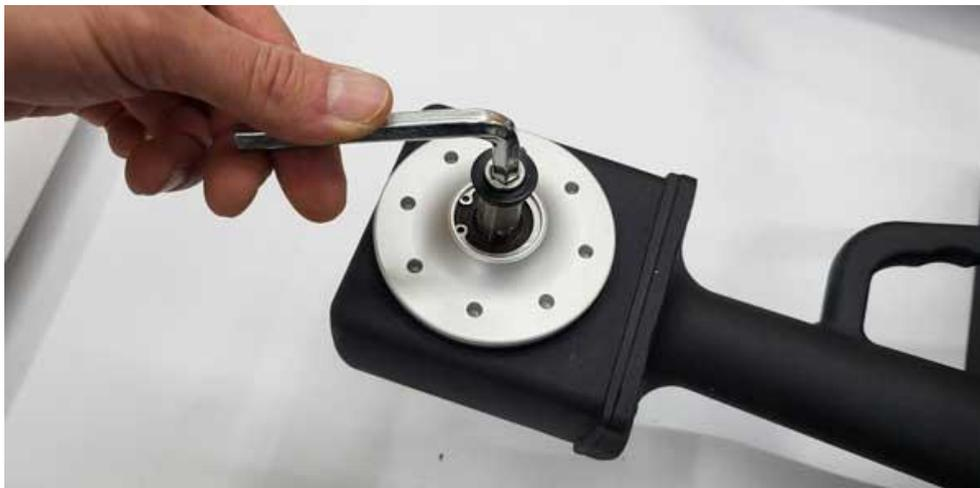
6. Das erste Pedal aufsetzen und die Schraube wieder in das Gewinde schrauben.
