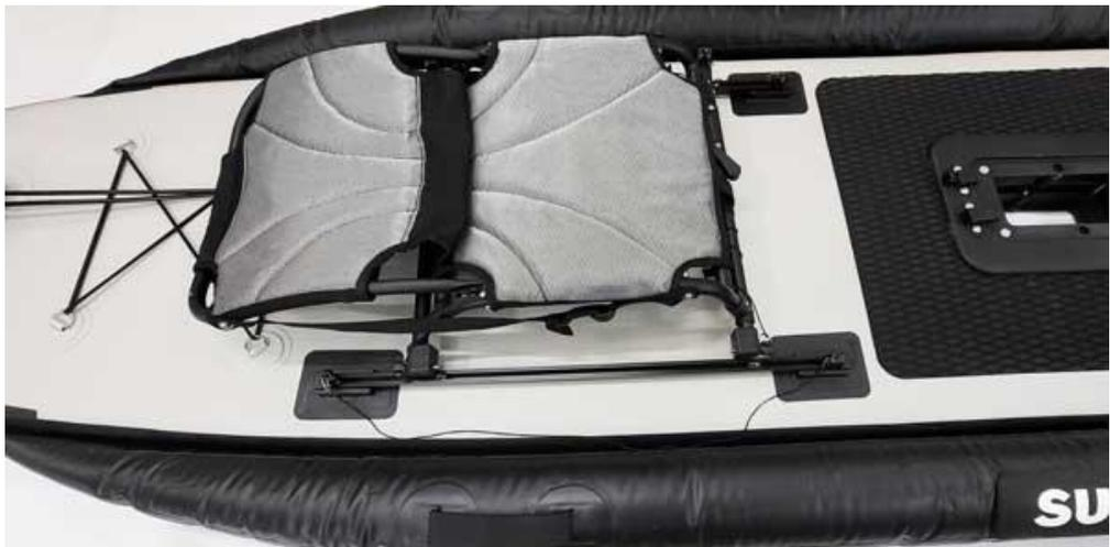
**14. Den Sitz mit den Schnellverschraubungen auf der Schiene verschrauben.**
