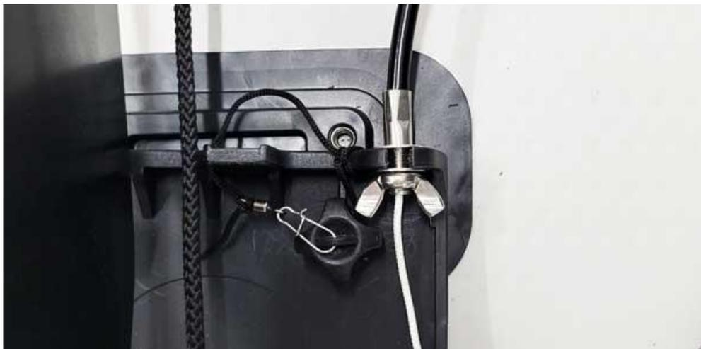
**18. Das Seil an dem Ruder befestigen und mit dem Schnellspanner gleichmäßig auf beiden Seiten spannen. (Dies muss erfolgen, wenn sich der Lenkhebel in der Mittelstellung befindet.)**
