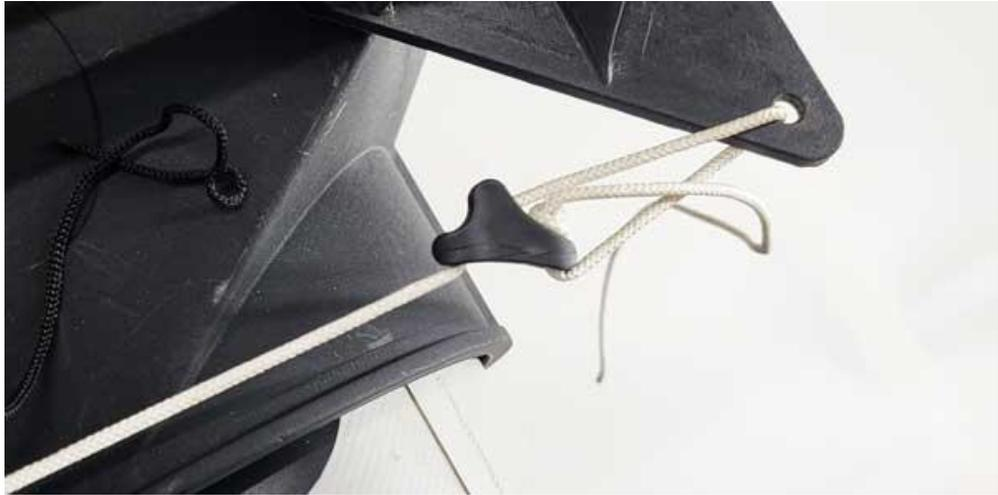
**19. Das Seil zum ein- und ausklappen des Ruders an dem Sitz befestigen.**
