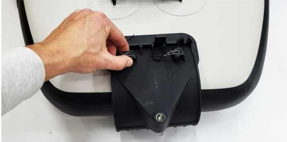
10. Die T-Nuten Muttern von dem Sitz in die Schienen einführen.
